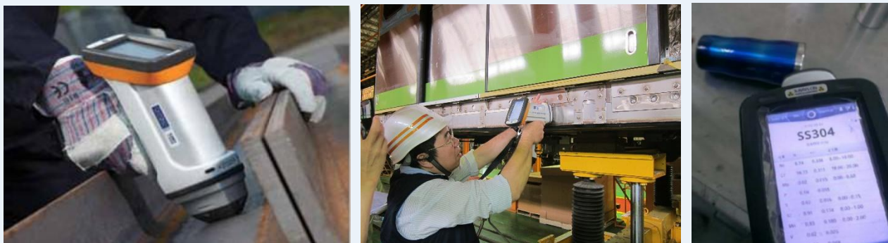
圖 44 現場使用手持式金屬成分分析儀檢測分析不銹鋼
