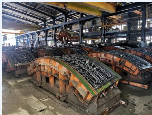
鋼筋籠置入鋼模，準備混凝土澆置
