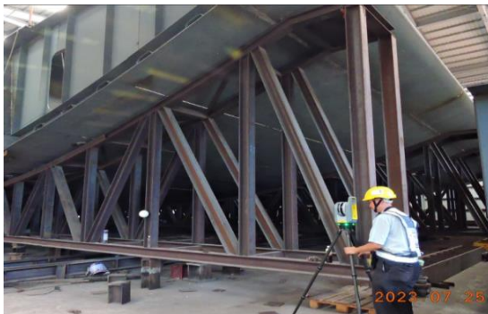
圖 25. 鋼梁試拼裝 3D 雷射掃描
