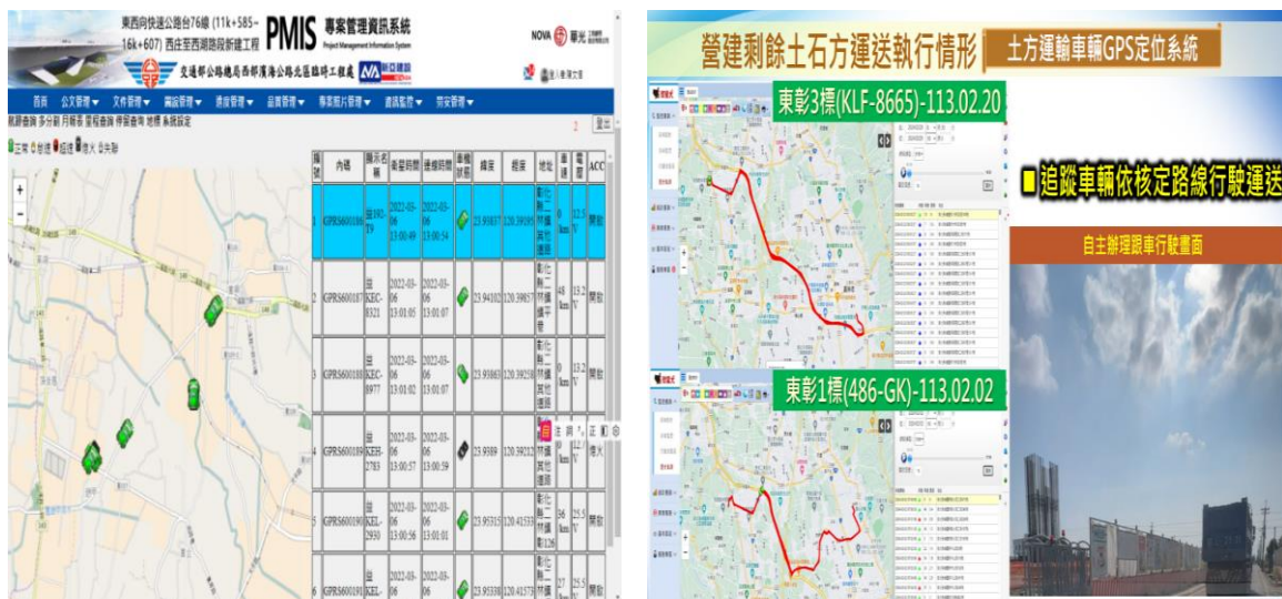
圖 11. 利用 GPS 定位系統智慧監控土石方運送車輛動態
