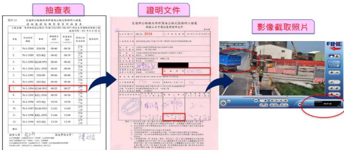
圖 10. 運用 PMIS 專案管理資訊系統進行遠端監控及表單管理作業
