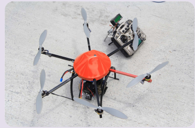
河川監控小幫手—六懸翼直昇機
