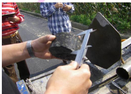
油壓尺測量高度是否符合
